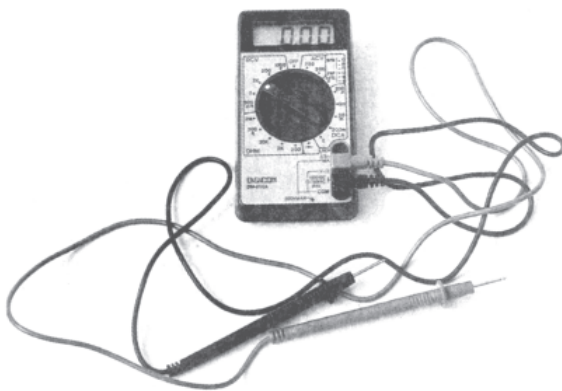
รูป 1.2 แสดงเครื่องมือวัดแบบแสดงผลด้วยตัวเลข
