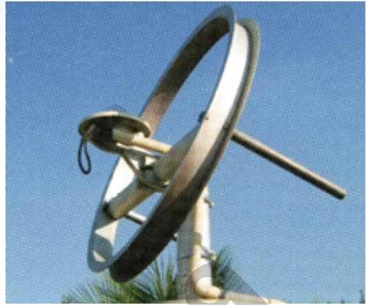
ข. โพรานอมิเตอร์วัดรังสีกระจาย (เสริม จันทรฉาย, 2557)
