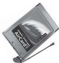
ตัวอย่างโมเด็มไร้สาย หรือ AirCard ที่ใช้เสียบกับช่อง PCMCIA ที่เครื่องคอมพิวเตอร์โน้ตบุ๊กพีซี
