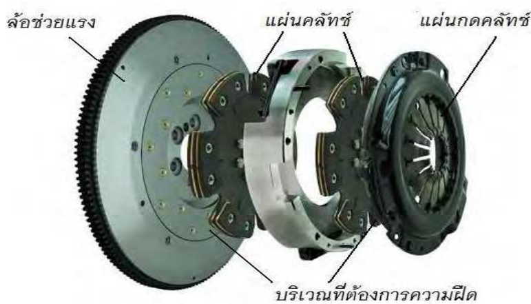
รูปที่ 1.7 การถ่ายทอดกำลังโดยชุดคลัทช์
