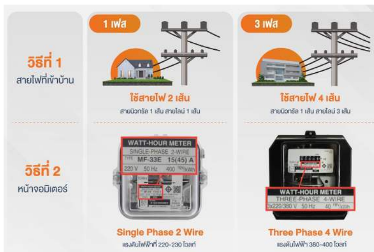
รูปที่ 1.5 วิธีสังเกตระบบไฟฟ้าหนึ่งเฟส และสามเฟส
