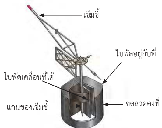
รูปที่ 1.5 โครงสร้างของมิเตอร์แบบใบพัดเหล็กเคลื่อนที่
