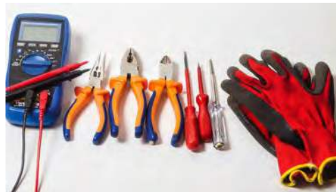
รูปที่ 1.2 มัลติมิเตอร์และเครื่องมือที่ใช้ตรวจสอบเครื่องว่าอยู่ในสภาพดีหรือชำรุด
