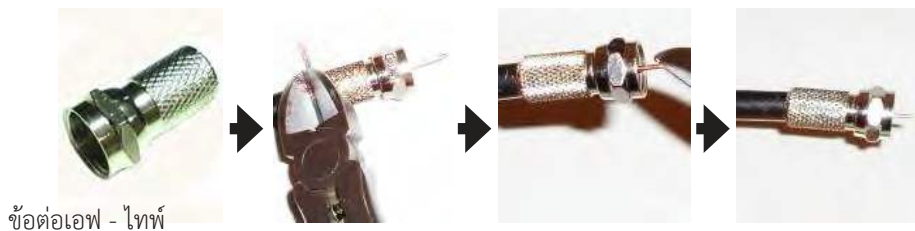
รูปที่ 1.1.4 ต่อเอฟ - ไทป์เข้ากับสายโคแอกเชียล
