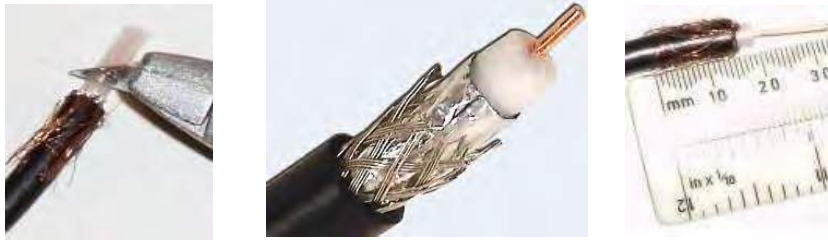
รูปที่ 1.1.2 ตัดรอบด้านในสายโคแอกเชียลออกเป็นส่วนต่าง ๆ ทั้งหมด
