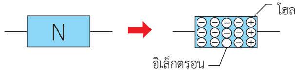
รูปที่ 1.10 สารกึ่งตัวนำชนิดเอ็นมีประจุไฟฟ้าลบมากกว่าประจุไฟฟ้าบวก
