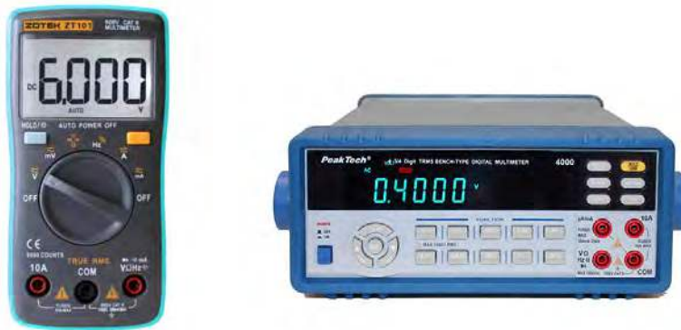
รูปที่ 1.5 ดิจิทัลมัลติมิเตอร์
