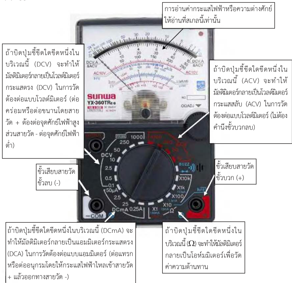
รูปที่ 1.4 แสดงการเลือกย่านการวัดให้กับมัลติมิเตอร์แบบเข็ม ที่มา http://www.chanthaburi.buu.ac.th
