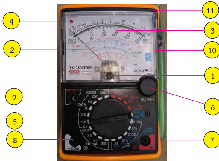
รูปที่ 1.1 ส่วนประกอบของมัลติมิเตอร์แบบเข็ม
