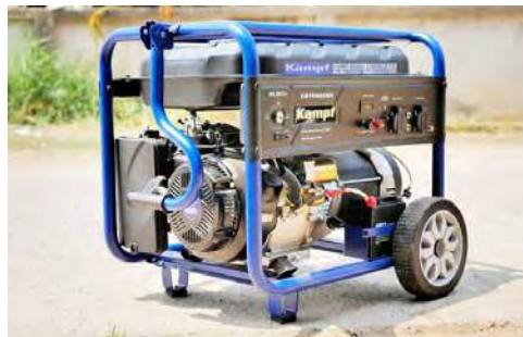
รูปที่ 1.11 เครื่องกำเนิดไฟฟ้ากระแสสลับขนาดเล็กมีกำลังไฟฟ้าระหว่าง 1 kVA - 20 kVA ใช้ในงานทั่วไปและงาน อดสาหกรรม
