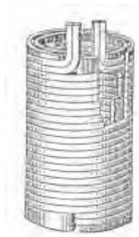
(ก) พันสองชั้นด้วยลวดตัวนำ ที่มีหน้าตัดเป็นรูปสี่เหลี่ยม
