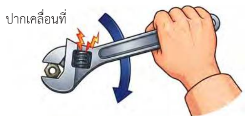
รูปที่ 1.7 วิธีการใช้ประแจเลื่อนที่ไม่ถูกต้อง
