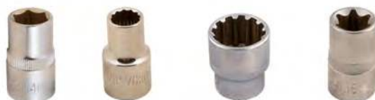
รูปที่ 1.11 ลักษณะเหลี่ยมของภายในประแจบล็อก
