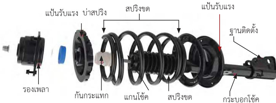
รูปที่ 1.34 ส่วนประกอบของระบบกันสะเทือนหน้าแบบแมคเฟอร์สัน สตรัท
