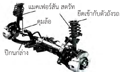
รูปที่ 1.22 ระบบกันสะเทือนหลังแบบสปริงขดสำหรับรถยนต์ขับเคลื่อนล้อหน้า ที่มา https://images.app.goo.gl
