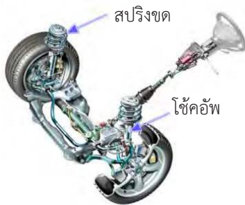
รูปที่ 1.21 ระบบกันสะเทือนหลังแบบสปริงขดสำหรับรถยนต์ขับเคลื่อนล้อหน้า ที่มา https://images.app.goo.gl
