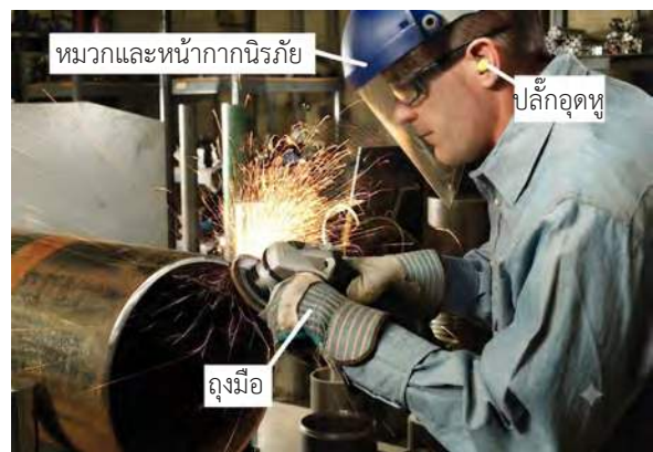
รูปที่ 1.3 วิธีใช้เครื่องมือแบบพาเวอร์
