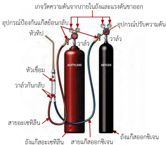
รูปที่ 1.3 กระบวนการเชื่อมแก๊สออกซิอะเซทิลีน
