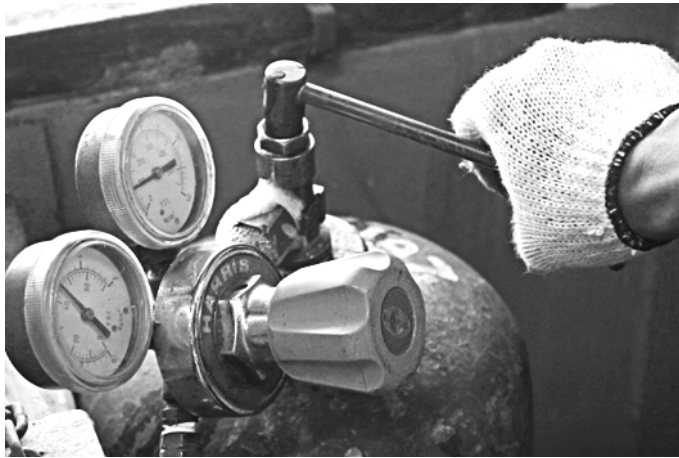
รูปที่ 1.5 แสดงการเปิดวาล์วถังแก๊สอะเซทิลีน
