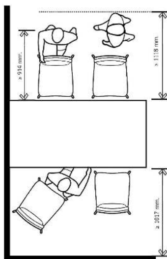
(ก) ระยะสำหรับ 4 ที่นั่ง และเผื่อระยะสำหรับการลุกออกแล้วเก้าอี้ไม่ติดผนังหรือขวางทางเดิน
