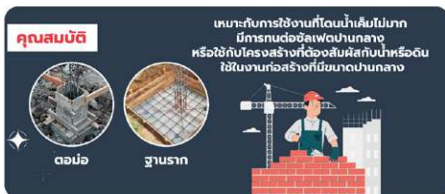
รูปที่ 1.8 ลักษณะการใช้งานปูนซีเมนต์ปอร์ตแลนด์ ประเภท 2
