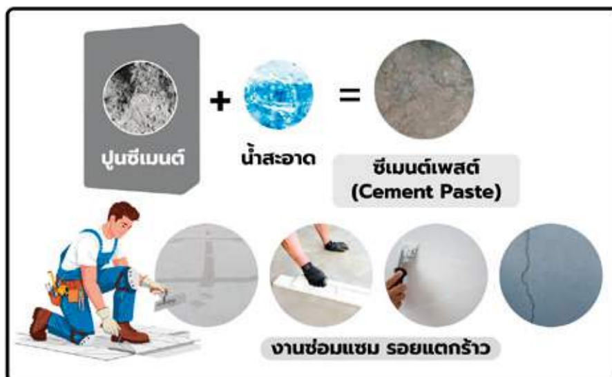
รูปที่ 1.15 ส่วนผสม และการใช้งานซีเมนต์เฟสท์
