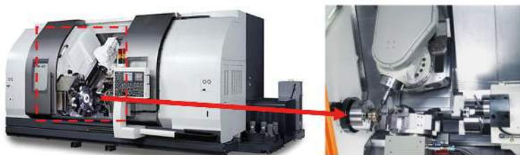
รูปที่ 1.9 เครื่องกลึง CNC แบบ Multitasking และการทำงาน (ที่มา : http://www.rbrmachinetools.com )
