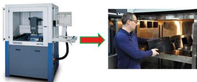
รูปที่ 1.36 เครื่องสร้างต้นแบบ 3 มิติ ( Rapid Prototyping Machine ) และการทำงาน (ที่มา : http://rpmttools.blogspot.com )
