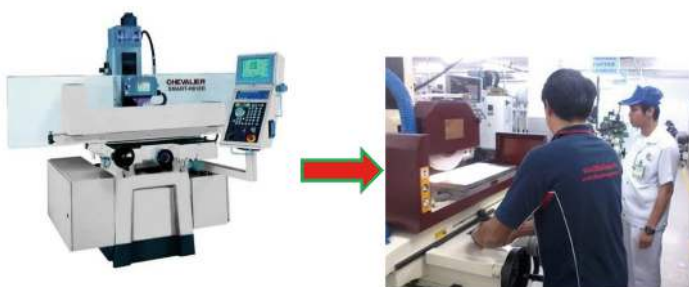
รูปที่ 1.16 เครื่องเจียระไนราบ CNC และการทำงาน (ที่มา : http://www.machinetools4sale.com )
