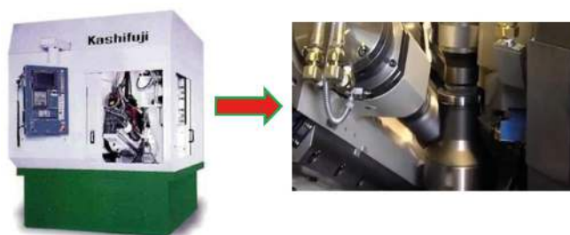
รูปที่ 1.12 เครื่องกัดผลิตฟันเฟือง CNC ( CNC Gear Hobbing Milling Machine ) และการทำงาน (ที่มา : http://www.involutegearmachine.com )
