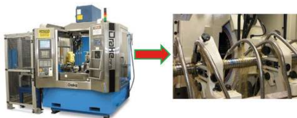
รูปที่ 1.20 เครื่องเจียรระโนเกลียว ซีเอ็นซี (CNC Thread Grinder Machine) และการทำงาน (ที่มา : http://drakemfg.com )
