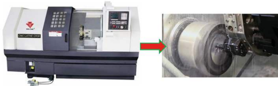
รูปที่ 1.8 เครื่องกลึง CNC และการทำงาน (ที่มา : http://czjyjc.en.made-in-china.com )
