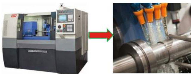
รูปที่ 1.15 เครื่องเจียระไนกลม CNC และการทำงาน (ที่มา : https://plus.google.com )
