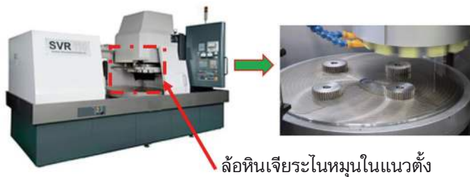
รูปที่ 1.18 เครื่องเจียรระโนชิ้นงานหมุนรอบตามแนวราบ CNC และการทำงาน (CNC Rotary Vertical Surface Grinder Machine) (ที่มา : http://www.shi.co.jp )
