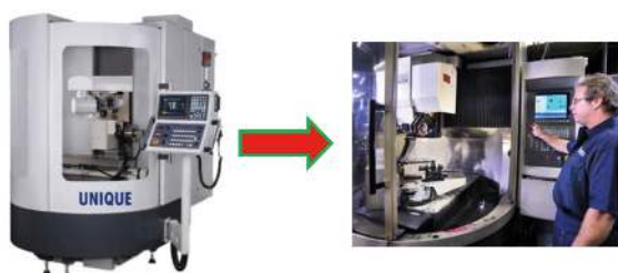
รูปที่ 1.25 เครื่องลับเครื่องมือตัดและการทำงาน (ที่มา : http://www.machinetooltw.com )
