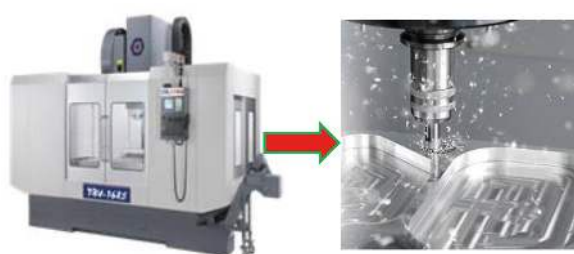
รูปที่ 1.11 เครื่อง Machining Center และการทำงาน (ที่มา : http://www.bigplazaa.com )
