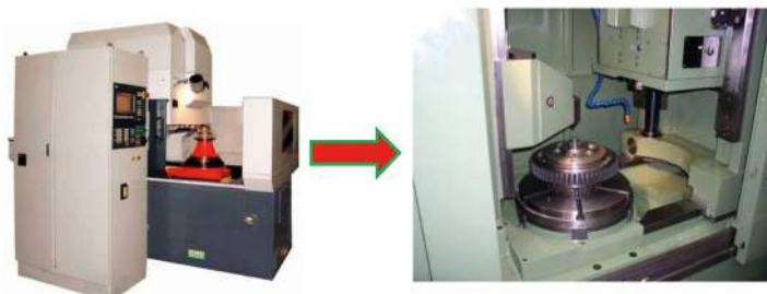
รูปที่ 1.13 เครื่องไสผลิตฟันเฟืองซีเอ็นซี และการทำงาน (ที่มา : http://www.gear-machine-tool.com )
