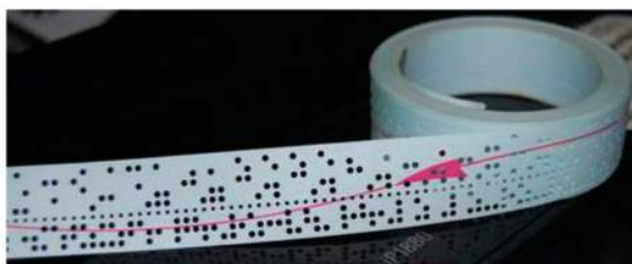
รูปที่ 1.5 ลักษณะของเทปกระดาษเจาะรู (ที่มา : http://thai.sewsense.com )
