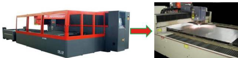
รูปที่ 1.29 เครื่องตัดแผ่นโลหะด้วยเลเซอร์และการทำงาน (ที่มา : http://www.p-wholesale.com )
