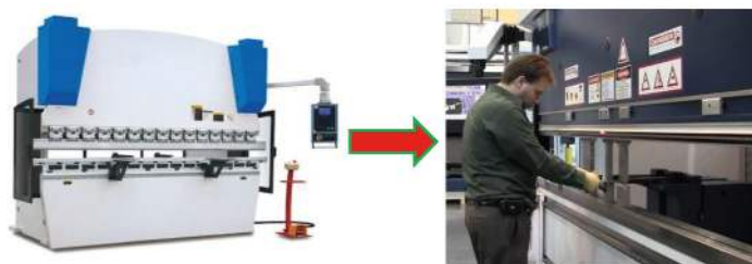
รูปที่ 1.33 เครื่องพับแผ่นโลหะและการทำงาน
