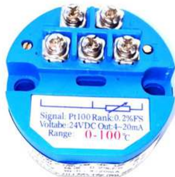
รูปที่ 2.4 Thermocouple Transmitter ส่งสัญญาณ 4–20 mA (ที่มา: บุญธรรม ภัทราจารุกุล, 2569)
