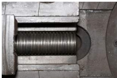
รูปที่ 1.11 ลีดสกรูในเครื่องกลึง (ที่มา: www.shutterstock.com )
