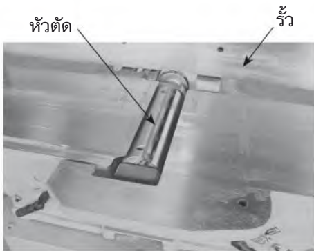
รูปที่ 2.35 แสดงการถอด ครอบคลุมใบเลื่อย และเลื่อนรื้อพ้นหัวตัด
