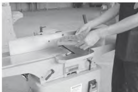
รูปที่ 2.21 แสดงการถอดกรอบคลุมหัวตัดออก
