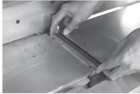
รูปที่ 2.31 แสดงการวางใบมีดและเหล็กประกบลงในร่องหัวตัด
