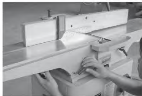
รูปที่ 2.33 แสดงการปรับแทนหลังให้สูงเท่าใบมีด
