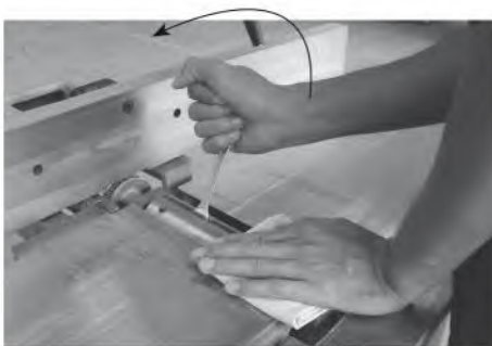
รูปที่ 2.29 แสดงการถอดเหล็กประกบใบมีดและใบมีด
