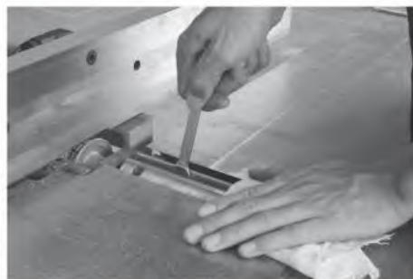
รูปที่ 2.34 แสดงการขันนอตยึดเหล็กประกบใบมีดให้แน่น
