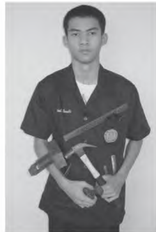
รูปที่ 1.8 แสดงการถือเครื่องมือที่ไม่ถูกต้อง
