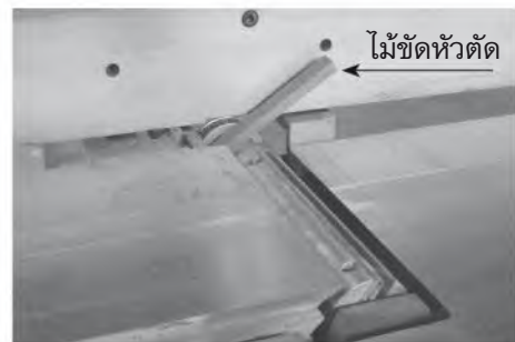
รูปที่ 2.36 แสดงการใช้ลิ้มไม้ขัดหัวตัดให้แน่น และลดแท่นหน้าลง
