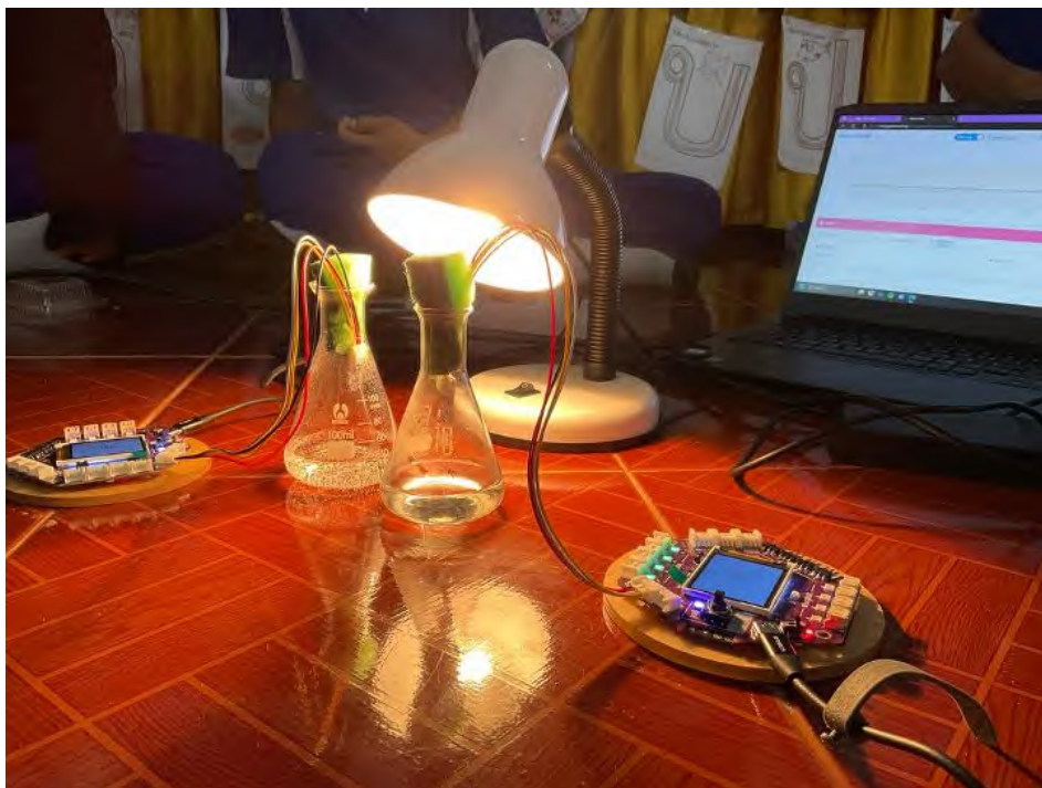
ภาพที่ 1 การใช้ GoGo Board วัดอุณหภูมิในแบบจำลองปรากฏการณ์ภาวะโลกร้อน
