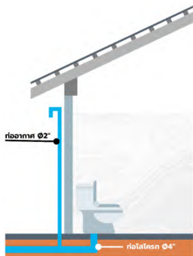
รูปที่ 1.4 การเดินท่อระบบระบายอากาศ ที่มา : กฤตวิทย์ รุ่งเรือง. 2569.
