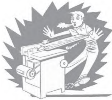
รูปที่ 1.3 การป้อนชิ้นงานเข้าสู่ตัวเครื่อง หากอยู่ในแนวการป้อนของชิ้นงาน อาจเกิดอันตรายจากชิ้นงานพุ่งเข้าใส่ได้ (ที่มา : Bench Woodwork)
