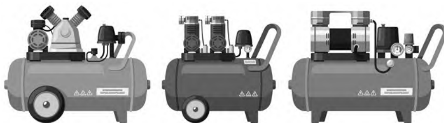
รูปที่ 1.9 แสดงต้นกำลังในการดูดอากาศมาอัด หรือเครื่องอัดอากาศ (Air Compressor)
