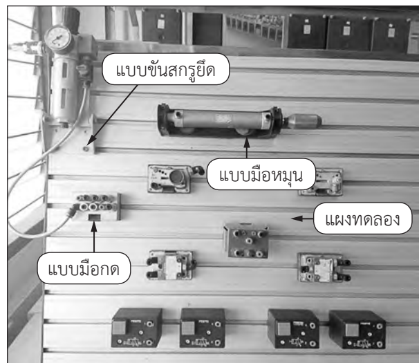
รูปที่ 1.7 แสดงการติดตั้งอุปกรณ์นิวเมติกส์บนแผงทดลอง
