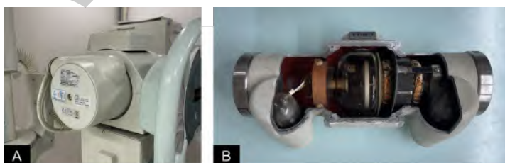
รูปที่ 1.3 ด้านนอกตัวเรือนหลอดเอกซเรย์ที่ถูกหุ้มด้วยแผ่นตะกั่ว (รูป A) และโครงสร้างด้านในของตัวเรือนหลอดเอกซเรย์เมื่อเจาะแผ่นตะกั่วออก ซึ่งจะมีโครงสร้างหลักคือหลอดเอกซเรย์ (รูป B)
