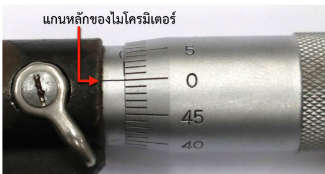
รูปที่ 1.5 เมื่อปิดสนิทแล้วแกนหลักของไมโครมิเตอร์ควรชี้ที่เลข 0 พอดี
