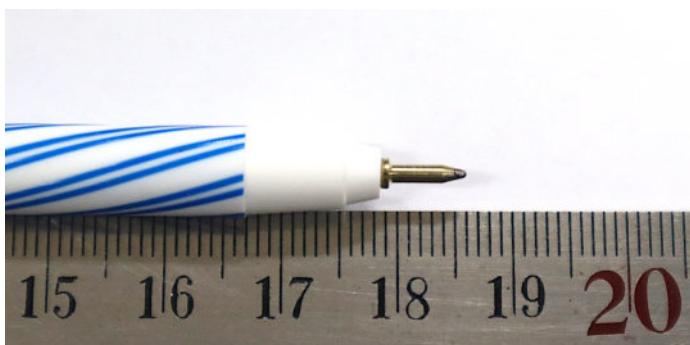
รูปที่ 1.2 เราวัดความยาวปากกาด้วยการเล็งดูว่าปลายปากกาด้านขวานั้นตรงกับขีดตัวเลขใดบนไม้บรรทัด
