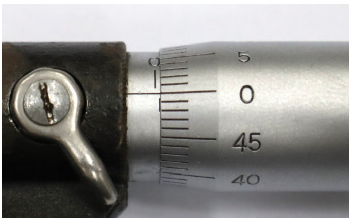
รูปที่ 1.6 แกนของไมโครมิเตอร์เคลื่อนที่ไปได้ 0.5 mm เมื่อเราหมุนด้ามครบ 1 รอบ
