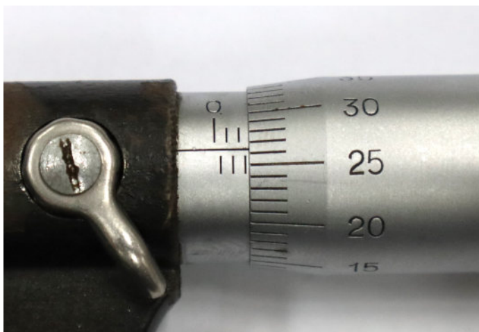
รูปที่ 1.7 ตัวอย่างไมโครมิเตอร์ที่หมุนออกมาแล้ว 5 รอบเศษ
