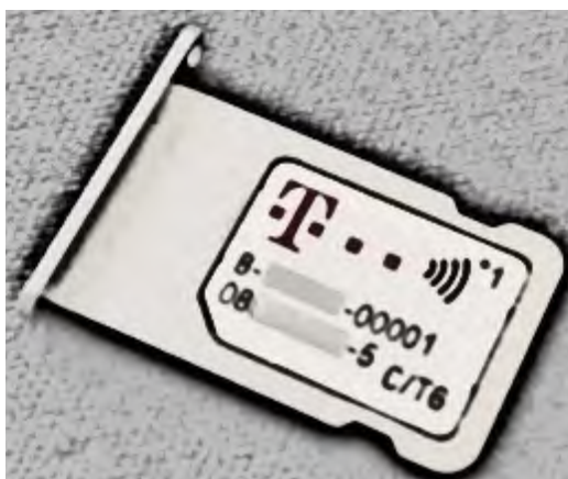
รูปที่ 1.7 Sim Card มีรอยบากที่มุมแทนที่จะเป็นรูปสี่เหลี่ยมพื้นผ้า เพื่อป้องกันการใส่ Sim ในตำแหน่งที่ผิด
