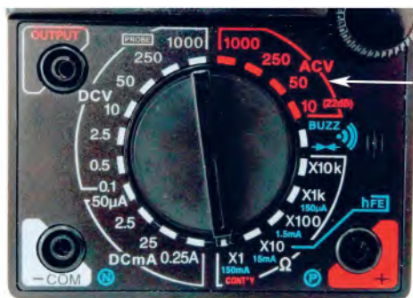
รูปที่ 1.14 แสดงย่านการวัดแรงเคลื่อนไฟฟ้ากระแสสลับ
