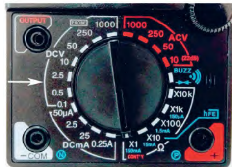
รูปที่ 1.10 แสดงย่านการการวัดแรงเคลื่อนไฟฟ้ากระแสตรง
