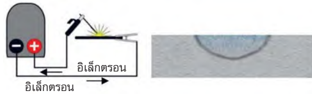
รูปที่ 1.10 แสดงวงจรการเชื่อมกระแสตรงอีเล็กโทรดขั้วบวก (ขั้ว) และภาพตัดขวางของรอยเชื่อม (ขวา) (ที่มา : ฉัตรทอง ไสแสง, 2562, หน้า 36)
