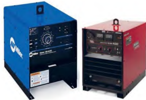
รูปที่ 1.8 แสดงลักษณะของเครื่อง แบบหม้อแปลงเรียงกระแส (ที่มา : ฉัตรทอง ไสแสง, 2562, หน้า 35)
