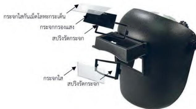
รูปที่ 1.23 แสดงการใส่กระจกใสกันเม็ดโลหะกระเด็นไว้ด้านนอกกระจกกรองแสง (ที่มา : ฉัตรทอง ไสแสง, 2562, หน้า 48)
