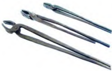
รูปที่ 1.27 แสดงลักษณะของคีมจับชิ้นงานร้อน (ที่มา : ฉัตรทอง ไสแสง, 2562, หน้า 51)
