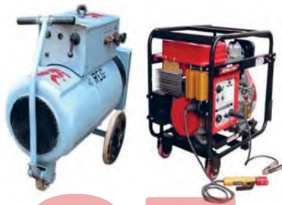
รูปที่ 1.6 แสดงเครื่องเชื่อมแบบเครื่องกำเนิดไฟฟ้าขับเคลื่อนด้วยมอเตอร์ไฟฟ้าและขับเคลื่อนด้วยเครื่องยนต์ (ที่มา : ฉัตรทอง ไสแสง, 2562, หน้า 32)
