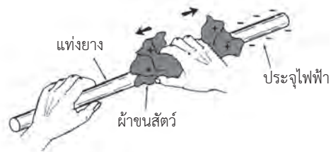
รูปที่ 1.4 การนำผ้าขนสัตว์มาถูกับแท่งยางจะเกิดไฟฟ้าสถิต (ที่มา : Frank J. Thiessen : 1994 : 130)
