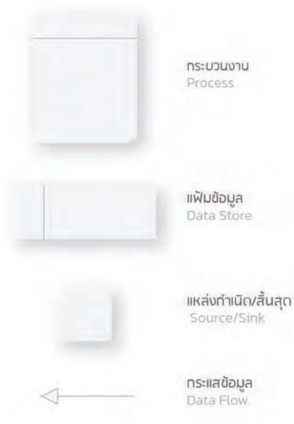
รูปที่ 2.1 สัญลักษณ์ของแผนภาพการไหลของข้อมูลแบบ Gane และ Sarson [2]
