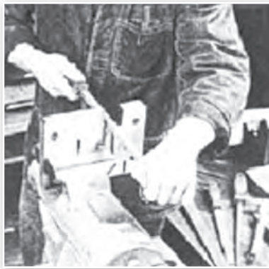
รูปที่ 1.3 การใช้ตะไบลบคมและตกแต่ง ร่องชิ้นงาน
