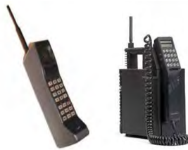
ภาพที่ 1.5 โทรศัพท์ระบบ NMT (Nordic Mobile Telephone)
