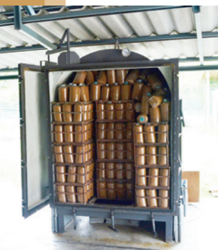
เตาเน้ความ ดันไอน้ำขนาด บรรจุ 650 ก้อน
