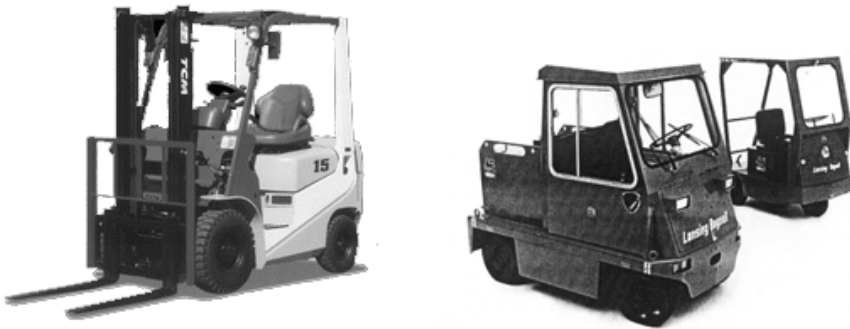
รูปที่ 1.10 อุปกรณ์ขนส่งด้วยเครื่องยนต์ เส้นทางขนส่งไม่แน่นอน
